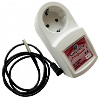
GSM-розетка ДОМОВОЙ-3 предназначена для дистанционного управления электроприбором пользователя (освещение, обогреватель, котел, маршрутизатор, сервер и т.д.) с помощью мобильного телефона, используя сеть сотовой связи. Контроль, подключенного к GSM-розетке, электрооборудования Вы можете осуществлять не только с помощью звонков и СМС со своего мобильного телефона, но и через любой компьютер, подключенный к Интернету.
