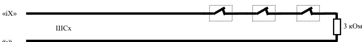
Если «Конфигуратором» в настройках проводных зон установлен тип шлейфа «параметрический охранный» (контролируется НАРУШЕНИЕ/ВОССТАНОВЛЕНИЕ датчика и «КОРОТКОЕ ЗАМЫКАНИЕ», «ОБРЫВ» шлейфа), то датчики с НЗ контактами необходимо подключать к прибору по следующей схеме:
