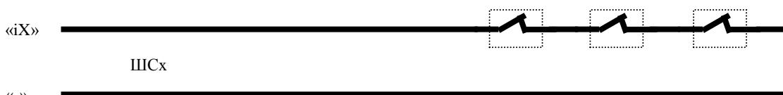
Если «Конфигуратором» в настройках проводных зон установлен тип шлейфа «классический охранный» (контролируется НАРУШЕНИЕ/ВОССТАНОВЛЕНИЕ датчика и «КОРОТКОЕ ЗАМЫКАНИЕ» шлейфа), то датчики с Н3 контактами необходимо подключать к прибору по следующей схеме:
