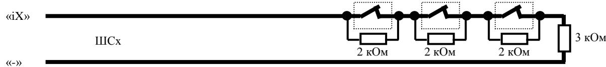
Если «Конфигуратором» в настройках проводных зон установлен тип шлейфа «двуихзонный параметрический ОКО» (контролируется НАРУШЕНИЕ/ВОССТАНОВЛЕНИЕ датчика зон-1,-5 или зон-2,-6 или зон-3,-7 или зон-4,-8, а также «КОРОТКОЕ ЗАМЫКАНИЕ», «ОБРЫВ» шлейфа), то датчики двух зон с НЗ контактами необходимо подключать к прибору по следующей схеме:
